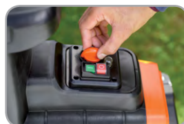
Interruptor de avance y retroceso
